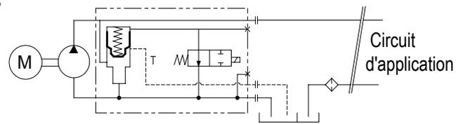
Un tuyau de drain doit être installé entre la valve by-pass et le réservoir hydraulique du véhicule afin d'assurer une circulation d'huile suffisante et permettre un bon refroidissement. Dans tous les cas, la connexion au réservoir doit se faire en dessous du niveau d'huile.
